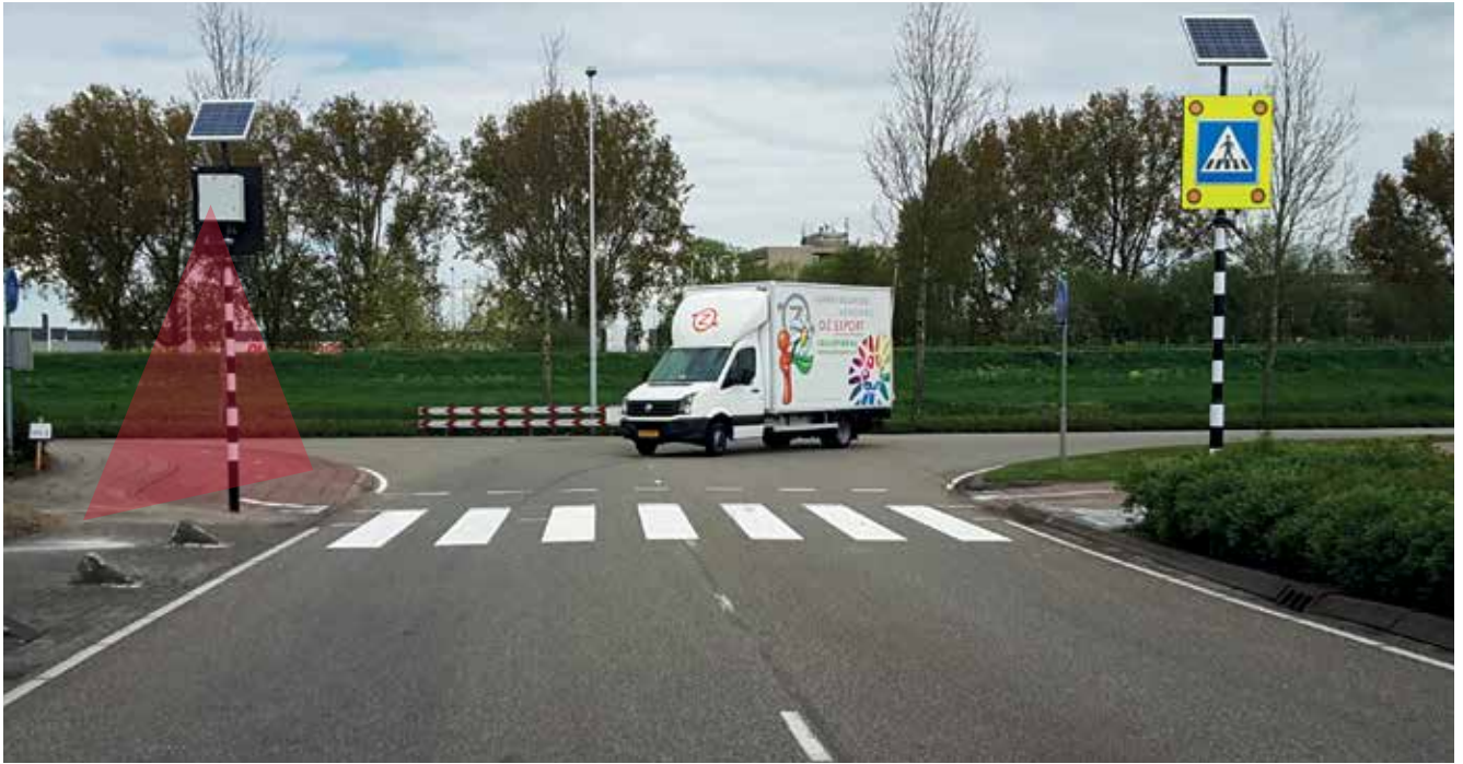
Opstelling met Infra-rood camera. In het rood de detectie zone van de camera.
