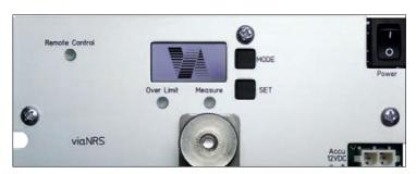
Via het bedieningspaneel in de accukast zijn de instellingen ter plaatse aan te passen.
