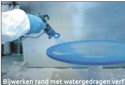
Bijwerken rand met watergedragen verf
